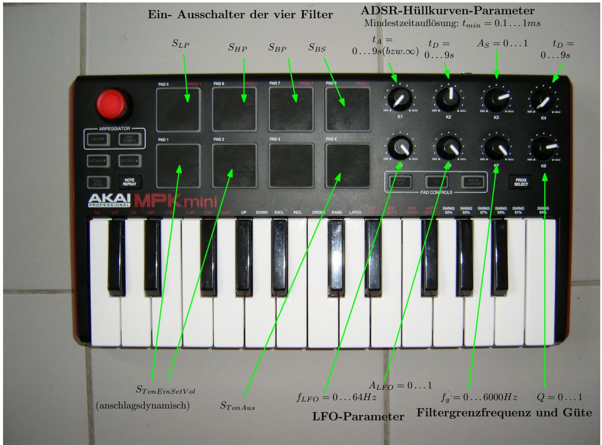
Abbildung 4: Zuweisung der Synthesizer-Parameter zu den Bedienelementen des Akai MPKmini-MIDI-Controllers/Sequencers.
